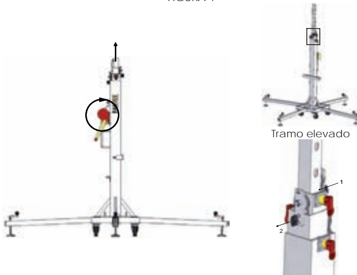
Giro del cabestrante y elevación del tramo
