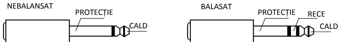
Figura 2–2: Atribuire balansată sau nebalansată a intrării în linie
