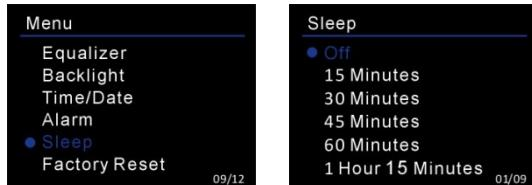
Drej på knappen < TUNING/SELECT> for at indstille indslumringstiden til 15/30/45/60/75/90/105/120 minutter eller for at slå den fra. Tryk på knappen < TUNING/SELECT> for at bekræfte valget.
