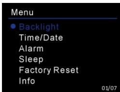
Du kan sette styrken til bakgrunnsbelysningen til High (Høy), Medium (Middels) eller Low (Lav), og du kan sette tidsavbrudd til On (På) / 10 / 20 / 30 / 45 / 60 / 90 / 120 / 180 sekunder. Hvis du har stilt inn tidsavbrudd, vil baklyset automatisk dempes hvis ingen knapper trykkes i løpet av den innstilte tiden.
