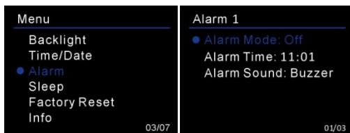
Draai de knop < **TUNING /SELECT**> om de instelling te kiezen voor alarm 1 of alarm 2.
