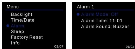
Tournez le bouton < **TUNING /SELECT**> pour choisir de régler Alarm1 ou Alarm2. Appuyez sur le bouton < **TUNING /SELECT**> pour entrer dans les réglages avancés.
