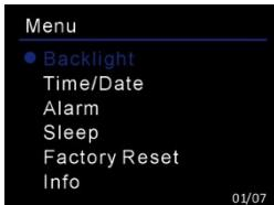
Sélectionnez le niveau de luminosité du rétro éclairage (Haut / Moyen / Bas) et la durée de l'affichage rétro éclairé (ON / 10/20/30/45/60/90/120/180 sec). Lorsque vous avez réglé la durée, le rétro éclairage diminuera automatiquement lorsque aucune action n'est effectuée sur l'appareil pendant la durée réglée.
