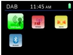
Druk op de toets **MODE** om het hoofdmenu te openen, draai de knop < **TUNING /SELECT**> om van gebruiksmodus te wisselen (DAB, FM, AUX-IN of Bluetooth) en druk vervolgens ter bevestiging op de knop < **TUNING /SELECT**>.
