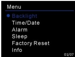
Vælg styrken af baggrundslyset (høj/mellem/lav) og hvor lang tid det skal være tændt (til/10/20/30/45/60/90/120/180 sek.). Ved at indstille tidsudløbet, dæmpes baggrundslyset automatisk, hvis enheden ikke benyttes i henhold til den indstillede tid.
