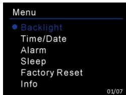
Selecteer het verlichtingsniveau van het achtergrondlicht (hoog/gemiddeld/laag) en de tijdsduur voor de time-out (aan/10/20/30/45/60/90/120/180 sec.). Wanneer u de time-out instelt, dan zal het achtergrondlicht automatisch dimmen als het apparaat niet wordt gebruikt gedurende de ingestelde tijd.
